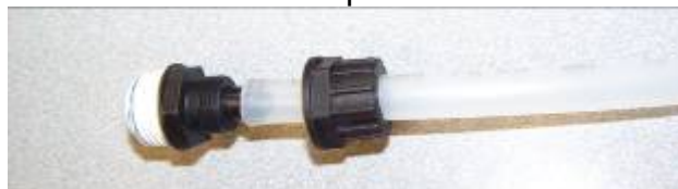
Figure 8. mise en place du tube sur les raccords
